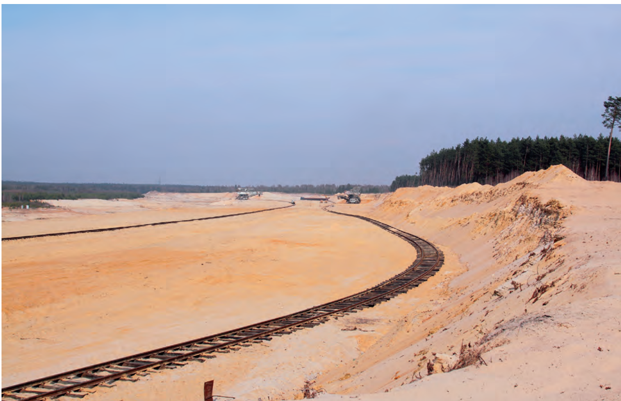
Kopalnia piasku „Kotlarnia” na terenie Nadleśnictwa Rudy Raciborskie – sprawca dwudziestometrowej głębokości leju depresyjnego, obejmującego zasięgiem tysiące hektarów lasu (K.F.)
